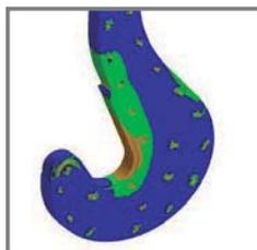
Estructura validada mediante análisis de Elementos Finitos
