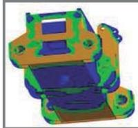
Structure validée au moyen d'analyse d'Éléments Finis
