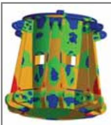
Estructura validada mediante análisis de Elementos Finitos
